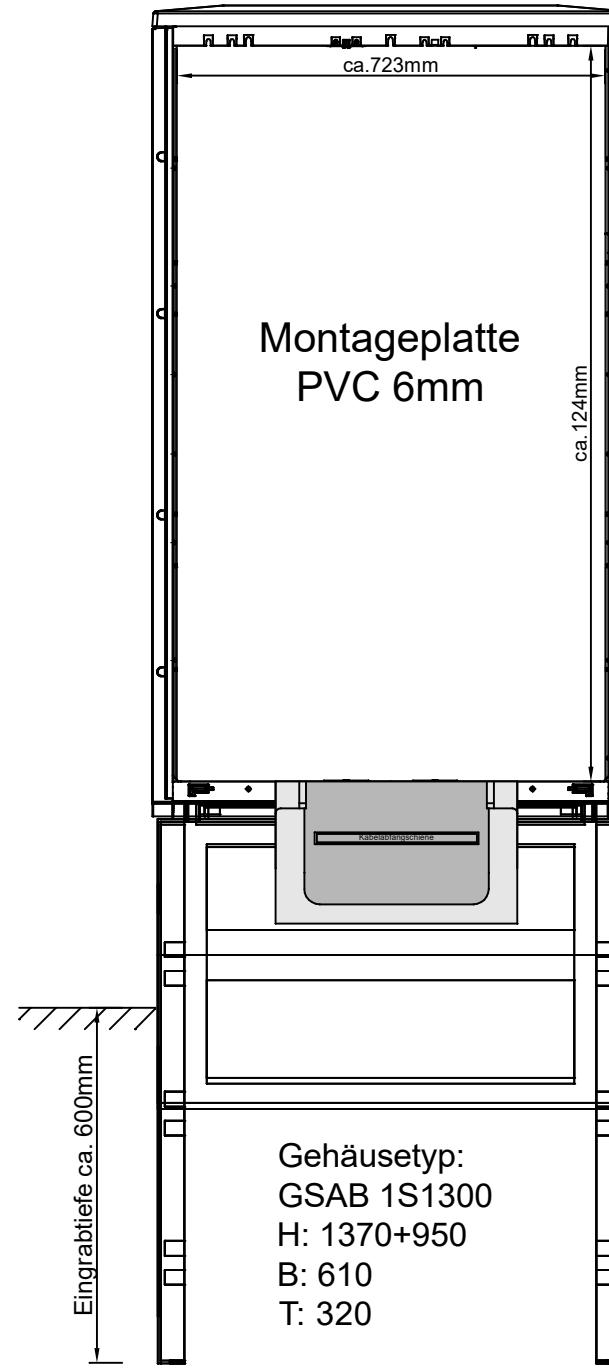
Socket 1FS (mit eingebauter FP-Einführung) ist sep. zu bestellen
