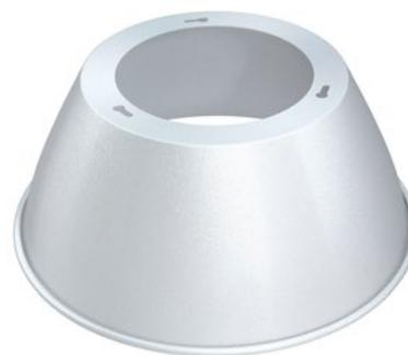
Der Reflektorschirm kann optional für die Hallenleuchten HBS6510040 und HBD6510040 verwendet werden. Dieser wird vorne auf die Leuchte aufgesetzt, wodurch der Ausstrahlwinkel von 120° auf 80° und außerdem der UGR-Wert auf 22 reduziert wird.
