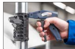
EVO cut: Stirnkappen designed zum sichern Schneiden.
