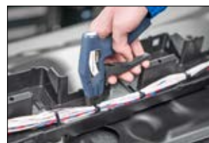
Sicheres Schneiden des Kabelbandes mit dem EVO cut.
