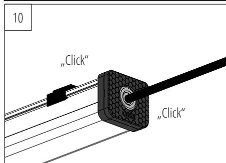
Anschluss der Durchgangsverdrahtung:
