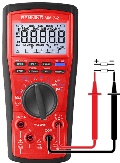
Ilustracja 11: Pomiar oporu lub test ciągłości obwodu
