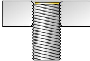
Bei allen bündigen *uprox<sup>+</sup>* Gewinderohrschaltern ist ein überbündiger Einbau erlaubt. Bei einem zurückgesetzten Einbau von 0,5 mm ist ein sicherer Betrieb gewährleistet.
