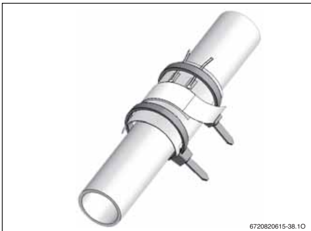
Bild 27 Montage des Taupunktfühlers (Beispiel)
