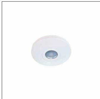
SITECO Connect, Multisensor, Montageart: Anbau, Vorschaltgerät: EIN/AUS, Netzanschluss: 220..240V, AC, 50/60Hz, Bemessungsleistung: 0,9W, Gehäuse, Gehäuse, rund, aus Kunststoff, weiß, Durchmesser: 120mm, Höhe: 25mm, Sensor PC14, lokale Steuerung - autarke standalone Sensorik, Ausstattung: Master, schaltbar, Schutzart (gesamt): IP20, Schutzklasse (gesamt): SK II (Schutzisoliert), Prüfzeichen: CE, UKCA, zul. Betriebsumgebungstemperatur: -20..+40°C, Verpackungseinheit: 1 Stück
