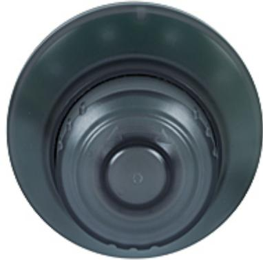
PITestop active, Not-Halt-Taster aktivierbar/deaktivierbar ohne Logo und ohne Nothaltsymbol nach EN 60947-5-1 und EN 60947-5-5, Entriegelung durch Drehen im oder gegen den Uhrzeigersinn, Einbaudurchmesser: 22,3 mm, IP65.
