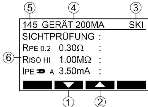
Abb. 48: AUTO-TEST Anzeige nach dem Drücken der Taste START (Beispiel, PC# 145 wurde als ein Wert für einen AUTO-TEST Code ausgewählt)
