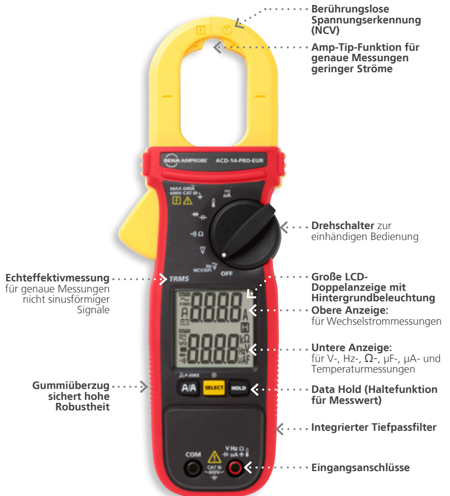
ACD-14-PRO-EUR Echtheffektiv-Strommesszange bis 600 A mit Doppelanzeige
