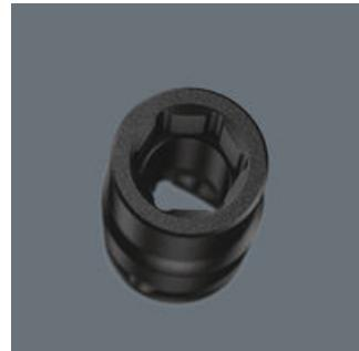
Das Sechskantprofil ermöglicht die Übertragung hoher Kräfte und belastet die Kanten der Schraubenmutter bzw. des Schraubenkopfes weniger als ein Zwölfkantprofil. Feinverzahnte Knarren machen darüber hinaus durch ihren kleinen Rückschenkwinkel den Einsatz eines Zwölfkantprofils auch in engen Raumverhältnissen überflüssig.
