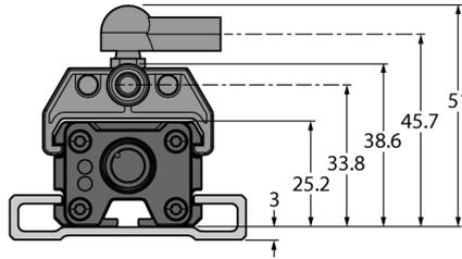
Umfangreiches Montagezubehör ermöglicht vielfältige Einbaumöglichkeiten. Bedingt durch das Messprinzip, das auf einer Schwingkopplung basiert, wird der Linearwegsensor nicht durch aufmagnetisierte Eisenteile oder sonstige Störfelder beeinflusst.
