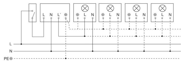
Schaltplan Anschluss über Serienschalter für Hand- und Automatik-Betrieb
