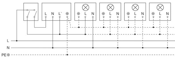
Schaltplan Anschluss 4-fach Tasterkoppler an DALI2 APC
