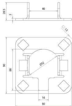
Anschlussplatte (vierfach) zur Montage der HVI light plus Leitung am Stützrohr Ø40 mm (z. B. Art.-Nr. 105 672, 105 673, 105 677, 105 678).
