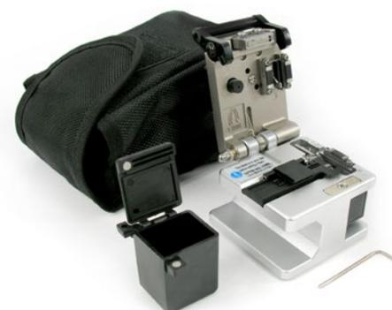
**+** Der OSMN ist ein Brechwerkzeug für 250 µm, 900 µm und Kabel mit 3 mm Außenschutz. Das **Präzisions-Brechwerkzeug** ermöglicht ein **schnelles** und **exaktes** Brechen der Faser (90°). Der Faserrest wird in einem Restbehälter aufgefangen. Der Faserschneider enthält Positionierungsführungen für Faser mit **250 oder 900 µm** sowie für Fasern mit einem Außenschutz von 3mm.
