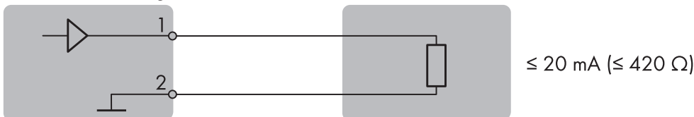
Abbildung 10: Anschluss einer analogen Gegenstelle
