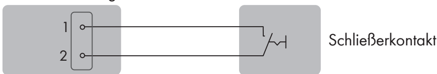
Abbildung 8: Anschlussbeispiel eines Schalters für den Schnell-Stopp
