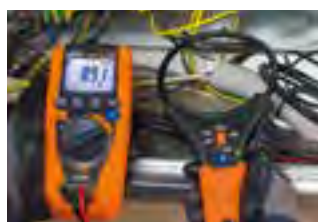
Messung des Stroms mit flexiblem Wandler.
