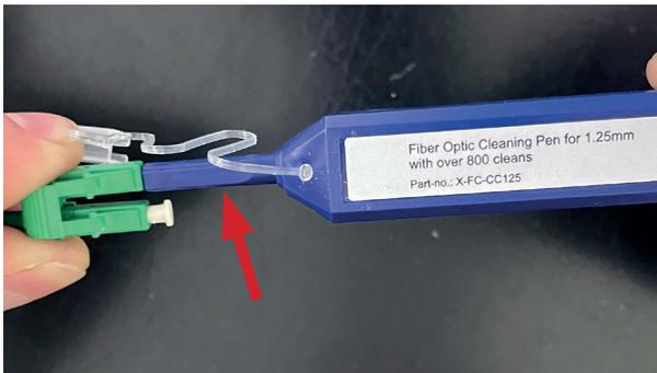
Abb.: Glasfaserreinigungsstift ansetzen und drücken
