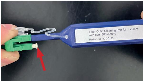
Abb.: Staubschutzkappe abziehen
