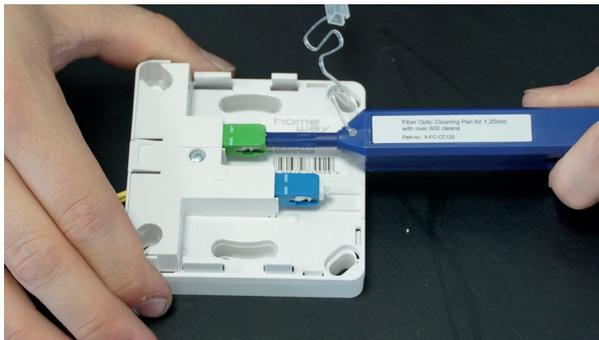
Abb.: Glasfaserreinigungsstift ansetzen und drücken
