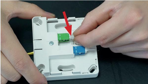
Abb.: Staubschutzkappe abziehen
