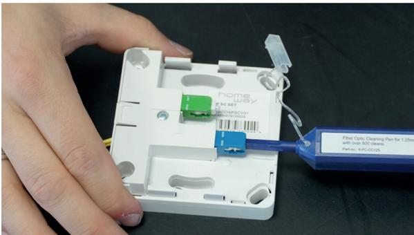
Abb.: Glasfaserreinigungsstift ansetzen und drücken
