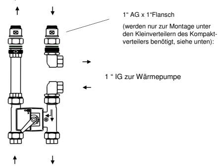
1 " IG zu alternativer Wärmequelle (z.B. Öl- oder Gaskessel)
