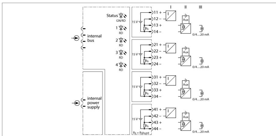
Das Eingangsmodul AI40-N dient zum Anschluss von 2-Leiter-Messumformern (aktiver Eingang = speisend / Geber passiv) und von 4-Leiter-Messumformern (passiver Eingang = nicht speisend / Geber aktiv).
