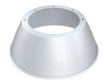
Der Reflektorschirm kann optional für die Hallenleuchten HBS6520040 und HBD6520040 verwendet werden. Dieser wird vorne auf die Leuchte aufgesetzt, wodurch der Ausstrahlwinkel von 120° auf 80° und außerdem der UGR-Wert auf 22 reduziert wird.
