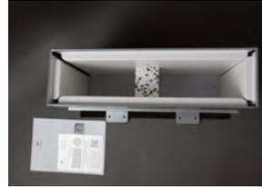
2. Ab einer Breite von 335 mm ist ein Styroporblock in der Lieferung enthalten. Dieser Block wird senkrecht und mittig in den Innenraum der BET Kabelbox geklemmt, damit sich die Box beim Eingießen nicht verformt.
