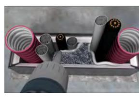
6. Danach werden alle Restöffnungen mit einem dauerelastischen Dichtstoff, wie z.B. Silikon oder Acryl, rauchdicht verschlossen.
